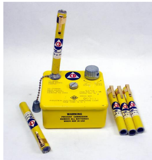
図 6 米国製ポケットチェンバー、CDV-750 ‘civil defense dosimeter’。高電圧を印加して泊を開き、被ばくした線量増加と共に箔が閉じていくのをクリップの側のレンズから光源を見ることにより、直読することが出来る。
