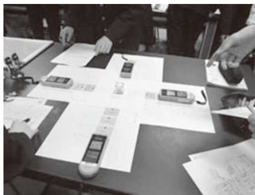
図8 放射線量と距離の関係を探る実験
