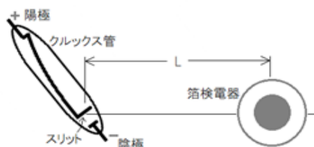
図1 クルックス管からの漏洩 X 線を箔検電器で測定するための配置図（上面図）
