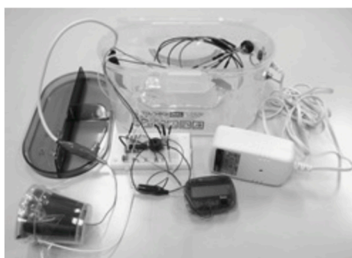
図2 簡易手作り GM 管を用いた放射線測定
