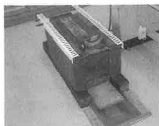
鉛の遮蔽装置 (検出器が入っている)
