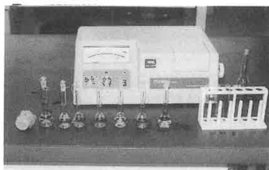
ザルツマン試薬を入れてピンク色が濃いほど \text{NO}_2 濃度が高い。
