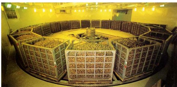
図5-4 ジャガイモの照射設備
