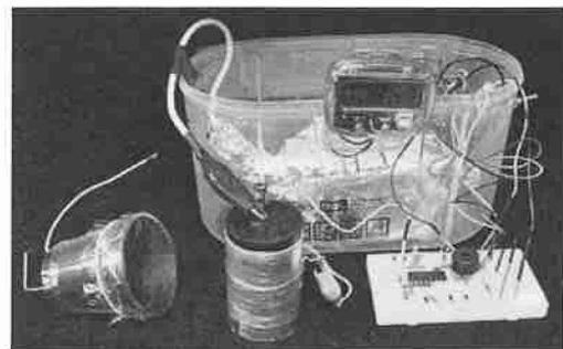
図6 手作り GM 管計数セット。写真は内部を取
