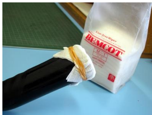
図 7. ベンコットと掃除機を用いて空気中のラドントロン娘核種を捕集している様子
